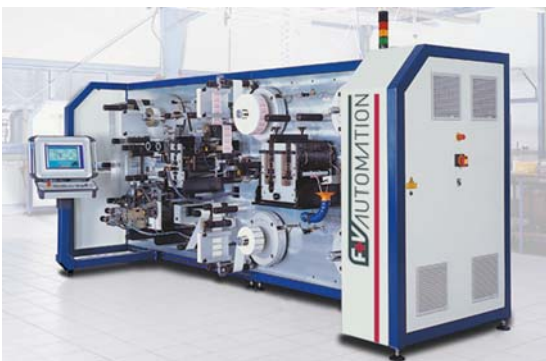
Die Konfektioniermaschine MC250 ist für RFID-Inlays und Tickets einsetzbar.
