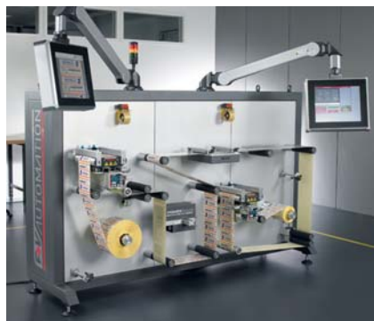
Mit dem Umroller RW250 lassen sich Produkte in verschiedenen Modi inspizieren.
